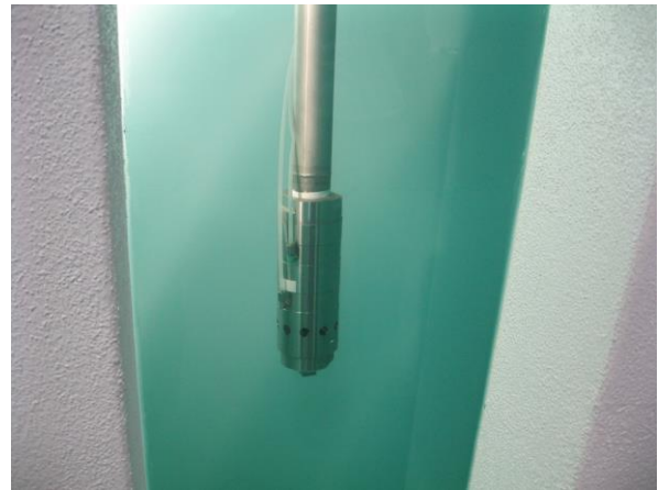
Figuur 25. Demonstratiemodel injectieklep in werkplaats Technology Trading.
